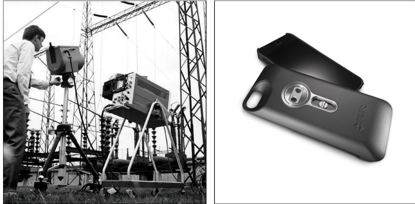
図 14.2 左: Thermovision Model 661、1969 年発売。カメラの重量は約 25 kg、オシロスコープは 20 kg、三脚は 15 kg です。オペレータは 220 VAC ジェネレーター セットと、液体窒素の入った 10 L 容器も必要です。オシロスコープの左側には、ポラロイドのアタッチメント (6 kg) があります。右: FLIR One、2014 年発売。iPhone に熱画像機能を提供するスライド式アタッチメントで重量は 0.9 kg です。
