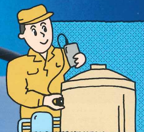
▲非磁性金属の溶射膜の皮膜厚測定
