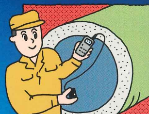
▲ライニング膜の皮膜厚測定
