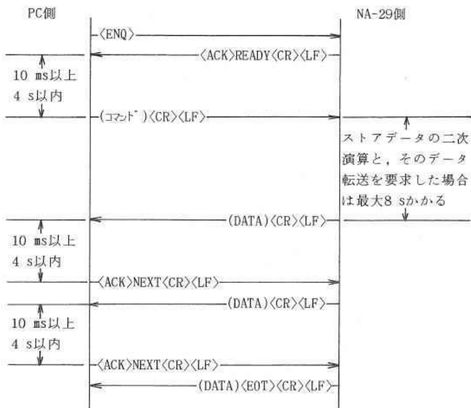
図2 データ転送と要求するコマンドを送る場合の手順
