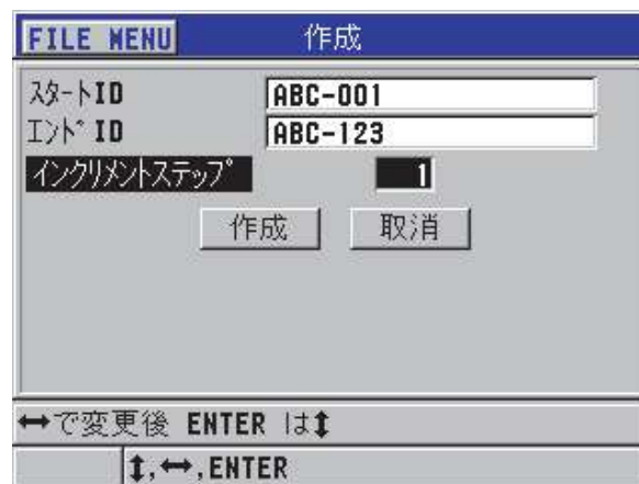
図 6-19 シーケンシャルファイルタイプに対する ID 範囲の選択
