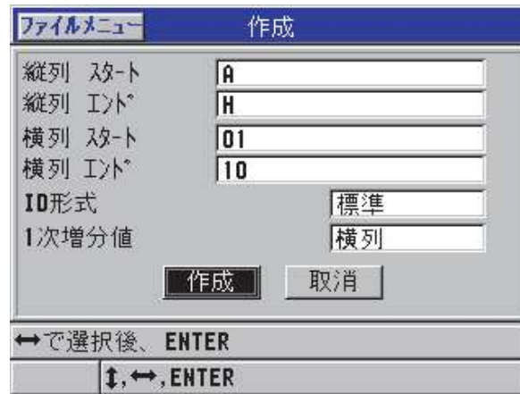
図 6-24 2-D グリッドデータファイルタイプに対する ID 範囲の設定
