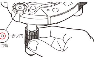
本体が±2°以上傾いている場合は、補正範囲外のためレーザーは自動的に消灯し、制御ランプ(緑)が早く点滅します。
