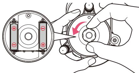
取付時は本体と電池フタの間に隙間が出来ないように外周部をしっかりと押さえて電池フタ止めネジを締めてください。
