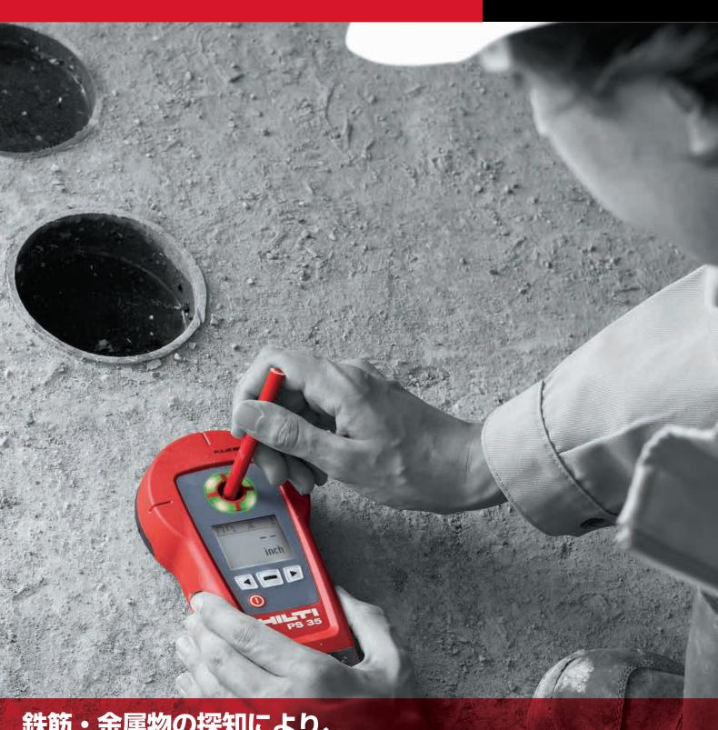
鉄筋・金属物の探知により、 コンクリートなどへの穴あけを能率的に
