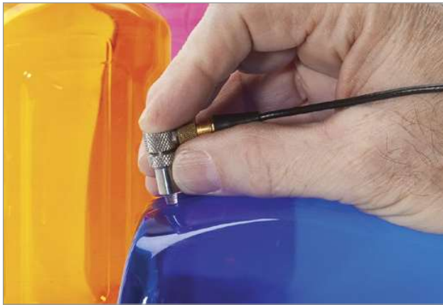
20MHz遅延材付き探触子により薄いプラスチック材を測定
