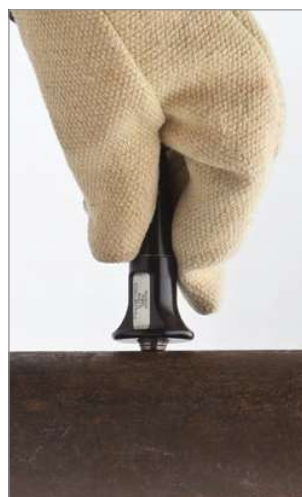
高温パイプ用D790-SM探触子
