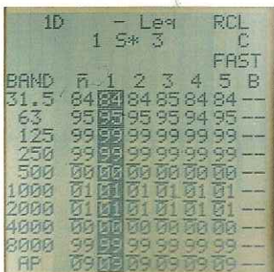
図13 音圧レベル差(音源)測定例
